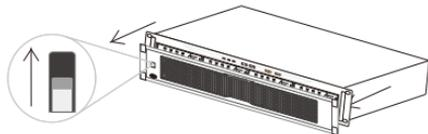
推动滑块，卸下保护盖，露出硬盘支架
