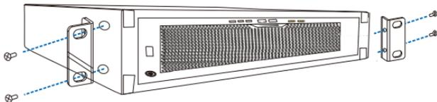
2) 将设备水平放在托盘上，使两侧挂耳的螺孔与机架上的螺孔重合，然后用螺钉固定。
